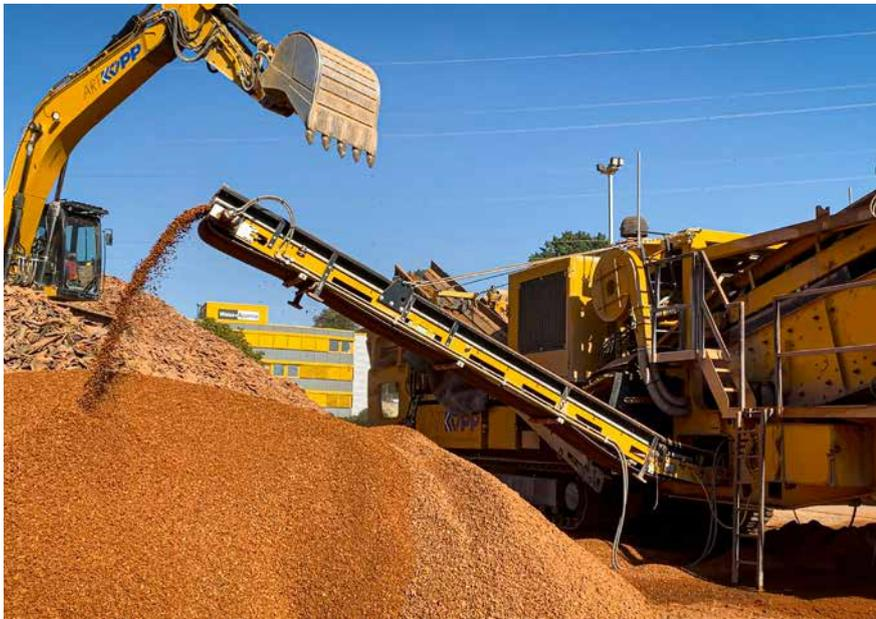
**Substrat à base de tuiles** Les vieilles tuiles peuvent être éliminées gratuitement dans le hall des substrats du centre d'exploitation de Weiss+Appetito Services spéciaux SA. Une fois par an, les tuiles sont cassées et criblées à l'aide d'une machine de concassage externe. Les granulés de tuiles concassées sont mélangés à du compost d'écorces et
